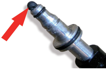
Bild 4: Wurde der alte Dichtring nicht entfernt, wird dieser in Richtung CSC gedrückt und verstopft die Leitung
