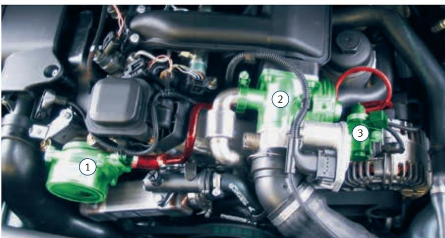
Beispiel BMW 118d (E87): Bauteile im Unterdrucksystem (grün), Unterdruckschläuche (rot)
