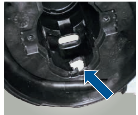
Schadensbild: Schmelzspuren am Gehäuse (Blick von oben in das Gehäuse)
