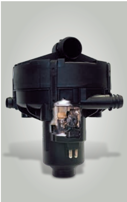
Blick in die Sekundärluftpumpe (geschnitten) mit Schmelzspuren
