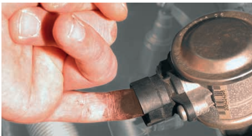
Schnellprüfung am Sekundärluftventil im BMW 520i (hervorgehoben)
