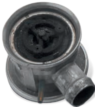
Schaden durch Abgaskondensat
