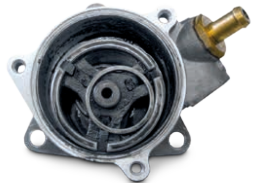
Schmierölmangel durch verunreinigtes, überaltertes Motoröl.
